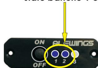
**ATTENZIONE: lo stato dei lampeggi non corrisponde allo stato istantaneo delle batterie bensì alla minima tensione delle batterie registrata dall'accensione.**
